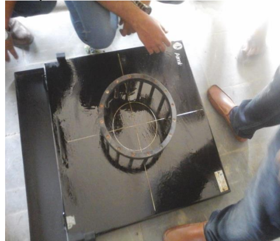
Fig: 4.2 J - ring test Apparatus
